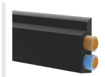
Die Flachbandleitung dient zur Spannungsversorgung der ConveyorControl und MultiControl. Die Außenkontur der Leitung entspricht dem Standard von AS-Interface. Der Mantel der Leitung verschließt Löcher, die durch Durchdringungskontakte entstanden sind. Das bedeutet, dass die Leitung auch nach Abklemmen von einer Steuerung die Schutzart hält.
