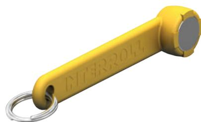
Der Magnetschlüssel mit einem hochwertigen Neodym-Magneten bietet viele Funktionen. Bei der MultiControl ermöglicht er das Umschalten des Bus-Protokolls oder die Verwendung des Teach-in-Verfahrens. Bei der ConveyorControl ermöglicht er das Adressieren oder beispielsweise die Durchführung eines Selbsttests.
